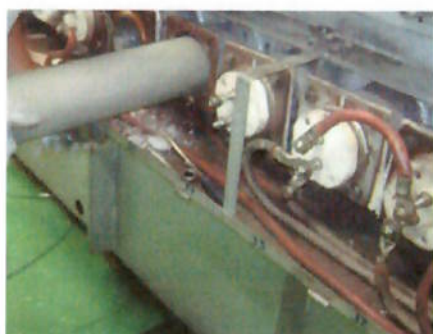
Figura 41 - Disposição das resistências e dos cabos de interligação.
