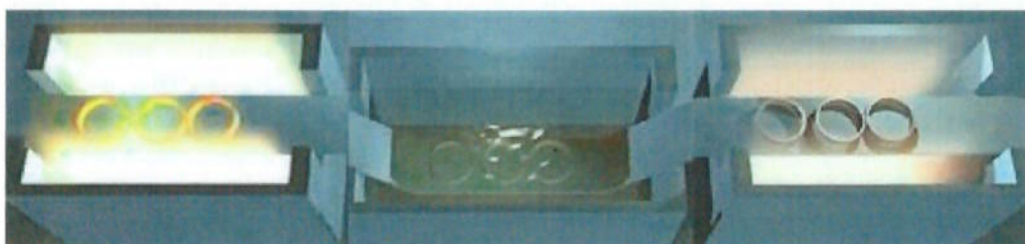
Figura 14 - Etapas do processo de tratamento térmico dos anéis de rolamentos de esferas.
