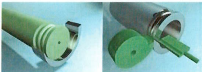
Figura 13 - Etapas do processo de tornearia dos anéis de rolamento de esferas
