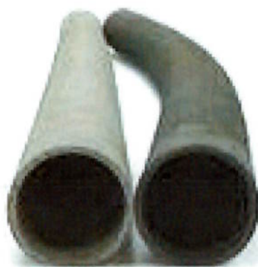
Figura 50 - Exemplo de flambagem dos tubos radiantes.
